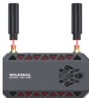
Montáž antén na konektory RP-SMA
