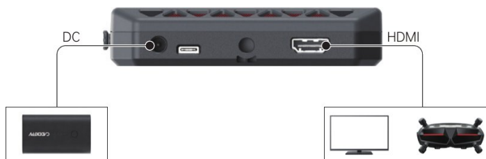
Zapojení: DC – akumulátor, HDMI – monitor nebo FPV brýle
