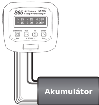
Správné připojení akumulátoru pro měření napětí
