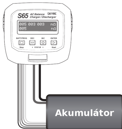
Správné připojení akumulátoru pro měření odporu
