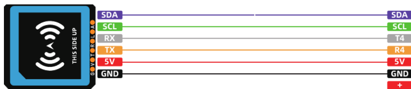
Připojení modulu GPS s kompasem
