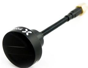
Foxeer Pagoda Pro – zářič v plastovém krytu, koaxiální kabel a konektor
