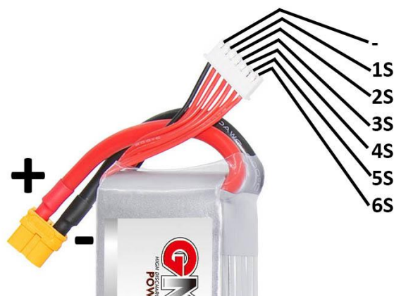
Obr. 1 – Hlavní konektor (XT60) vlevo a balanční konektor (JST-XH) pro konfigurace 6S vpravo
