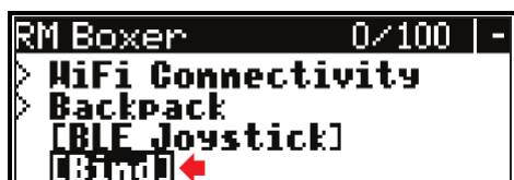
Obr. 2 – tlačítko [Bind] v LUA skriptu ExpressLRS
