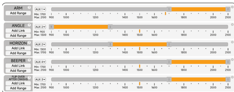
Karta Modes v Betaflight Configuratoru – výchozí rozsahy
