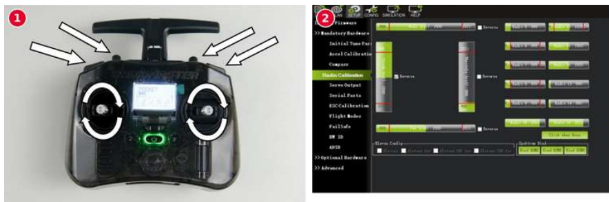
① pohyb pákami a přepínači · ② odezva v programu Mission Planner
