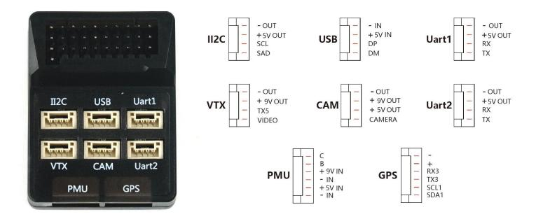
II2C : Blank USB : to PC UART 1 : Digital VTX VTX : Analog VTX CAM : to Analog UART 2 : Digital VTX Camera
