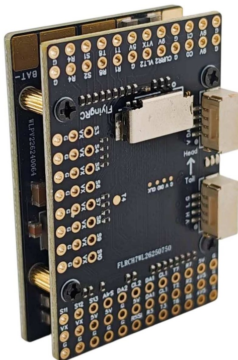
Sestava řídicí jednotky a napájecí desky
