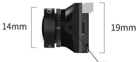
Rozměry kamery a boční montážní otvor pro šroub M2
