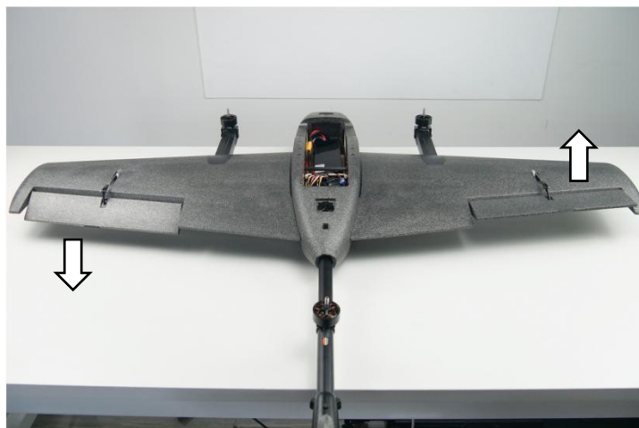
Levé křídélko by mělo směřovat dolů, pravé křídélko nahoru.
