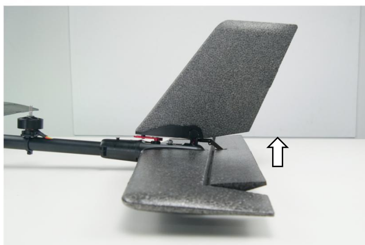
Horizontální řídicí plocha ocasní plochy by měla směřovat nahoru.
