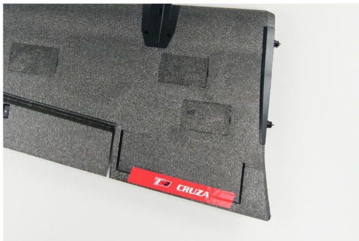
Nalepte nálepku přes otvor klapky (pokud klapky nejsou nainstalovány), abyste zabránili vibracím řídicí plochy klapky způsobeným prouděním vzduchu během letu.
